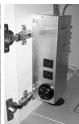
Lämpöaltaan virtakytkin ja termostaatti
