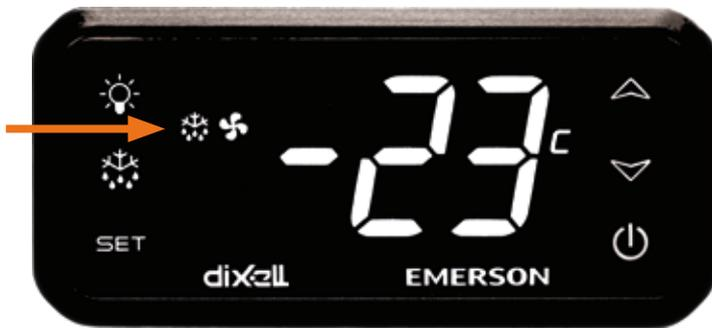
Sulatus on mahdollista kytkeä päälle manuaalisesti, jos lämpötila on alkanut nousta.
