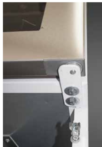
Nedre gångjärn, bild 2
