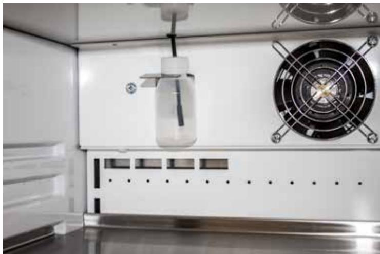
P4 övervakningssensor sätts i vätskeflaskan på skåpets bakre vägg. Lossa locket på flaskan så att den lossnar från ställningen.
