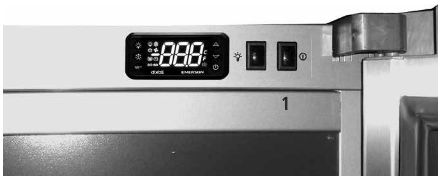
Paina pääkytkintä (1), jolloin näyttöön ilmestyy noin 10 sekunnin kuluessa kaapin sisälämpötilaa osoittava lukema.
