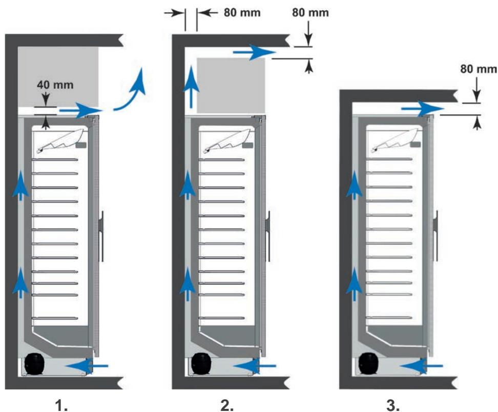
Jos laitteen yläpuolelle asennetaan täyssyvä yläkaappi, on laitteen ja yläkaapin väliin jätettävä vähintään 40 mm tyhjää ilmankiertotila (1). Jos yläkaappi on heti laitteen yläpuolella, kaapin taakse sekä kaapin ja katon väliin on jätettävä vähintään 80 mm tyhjää tila (2). Vapaasti seisovan laitteen ja huoneen katon välissä pitää olla vähintään 80 mm tyhjää tila (3).
