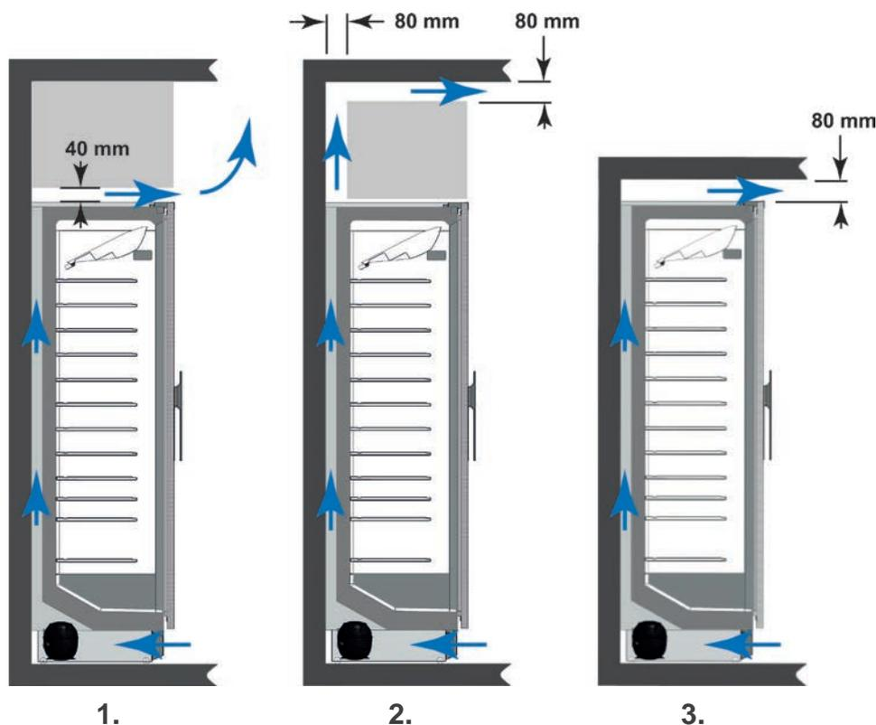
Om ett överskåp med full midja är monterat ovanför apparaten ska minst 40 mm tom luftcirkulation lämnas mellan apparaten och överskåpet (1). Om toppskåpet är omedelbart ovanför apparaten måste minst 80 mm tomt utrymme lämnas kvar bakom skåpet och mellan skåpet och taket (2). Det måste finnas minst 80 mm tomt utrymme mellan den löst installerade enheten och taket på rummet (3).
