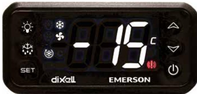
Tryck på frysens knapp minst 3 sekunder tills infrysningskontrollampa visas i display. Om den mängd som skall frysas in är densamma som uppgivits som infrysningseffekt per dygn (max 18 kg per gång), skall man låta maskinen gå en nedkylningsperiod (6 timmar) före infrysningen. Den elektroniska termostaten återgår automatiskt efter den 6 timmar långa nedkylningsperioden till förvaringstemperaturen.
